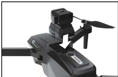
1. Démontage de l'équipement d'évitement d'obstacles comme indiqué
