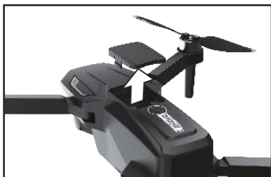
1. Retirer la couverture de l'emplacement d'installation de l'équipement d'évitement d'obstacles
